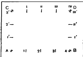
Նկ. 4.8. Քառակուսային ցանցի կառուցումը Ֆ.Բ. Դրոբիչչևի քանոնով
